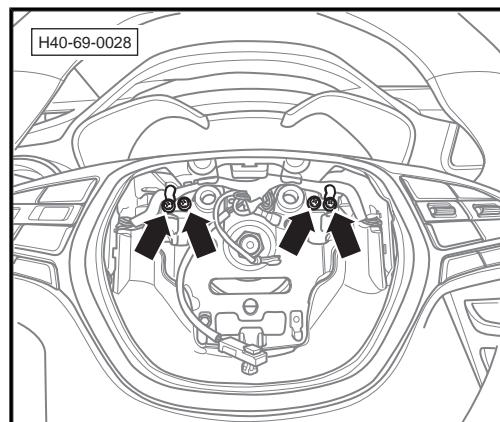
3. 从-箭头C-位置脱开方向盘多功能开关组件与方向盘的连接。
